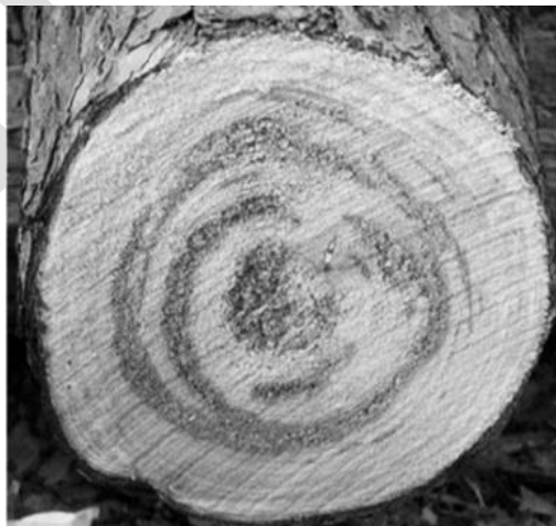
Мал. 12. Приклад серцевинної гнилі на поперечному перерізі колоди
