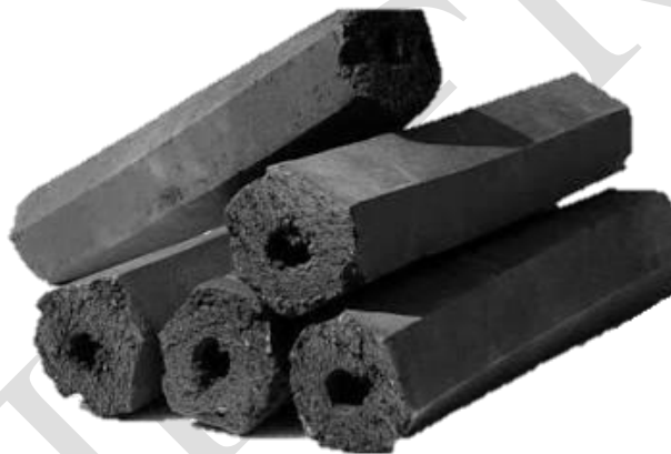
Мал. 2. Брикет паливні вугільні у формі багатогранника з отвором
